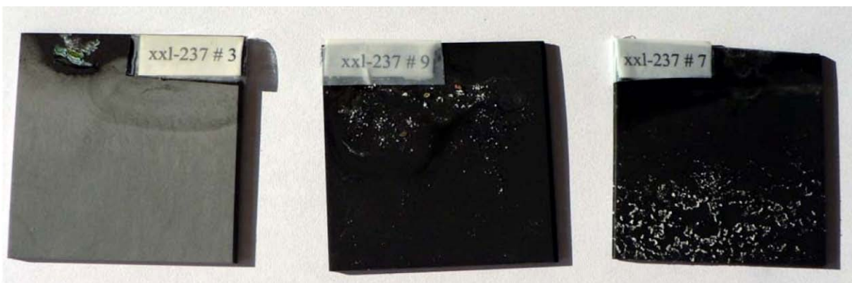
Abb. 4-35: Seite B von Anode, bipolarer Platte und Kathode nach der Elektrolyse
