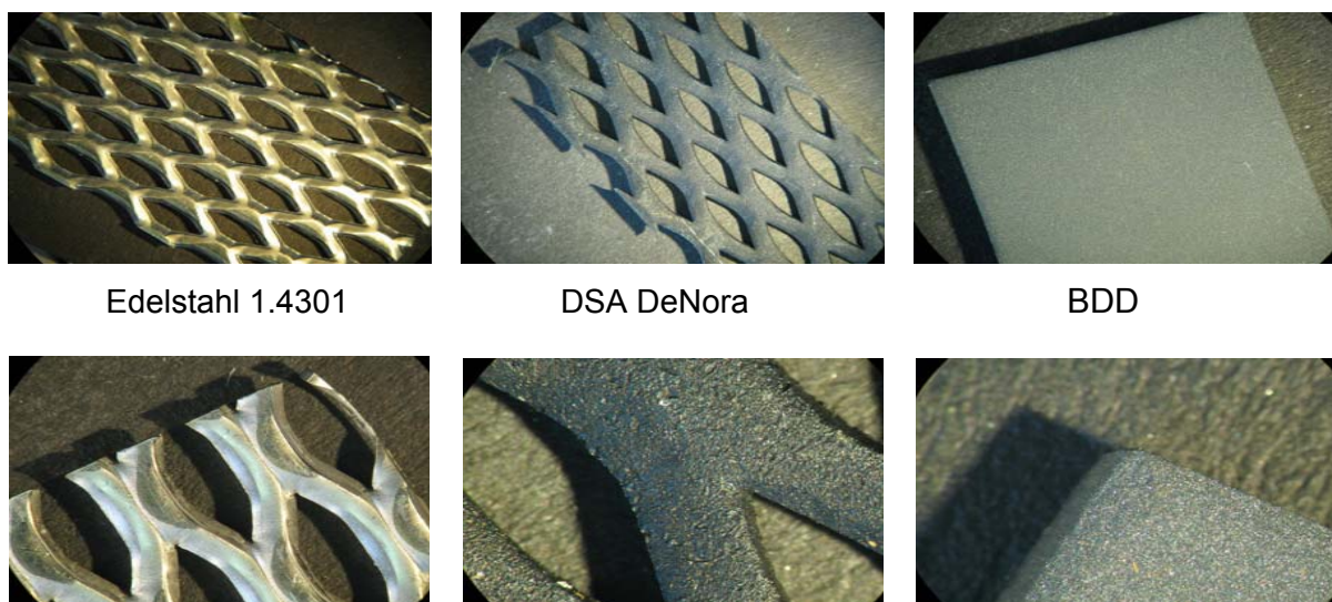
Abb. 4-36: Auslagerungsproben in Grundwasser aus Lahr
