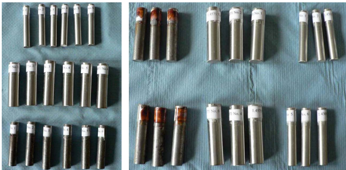
Abb. 4-29: Proben vor dem Einbau in den Aquifer (links) und nach 228 Stunden im elektrischen Feld (rechts)
