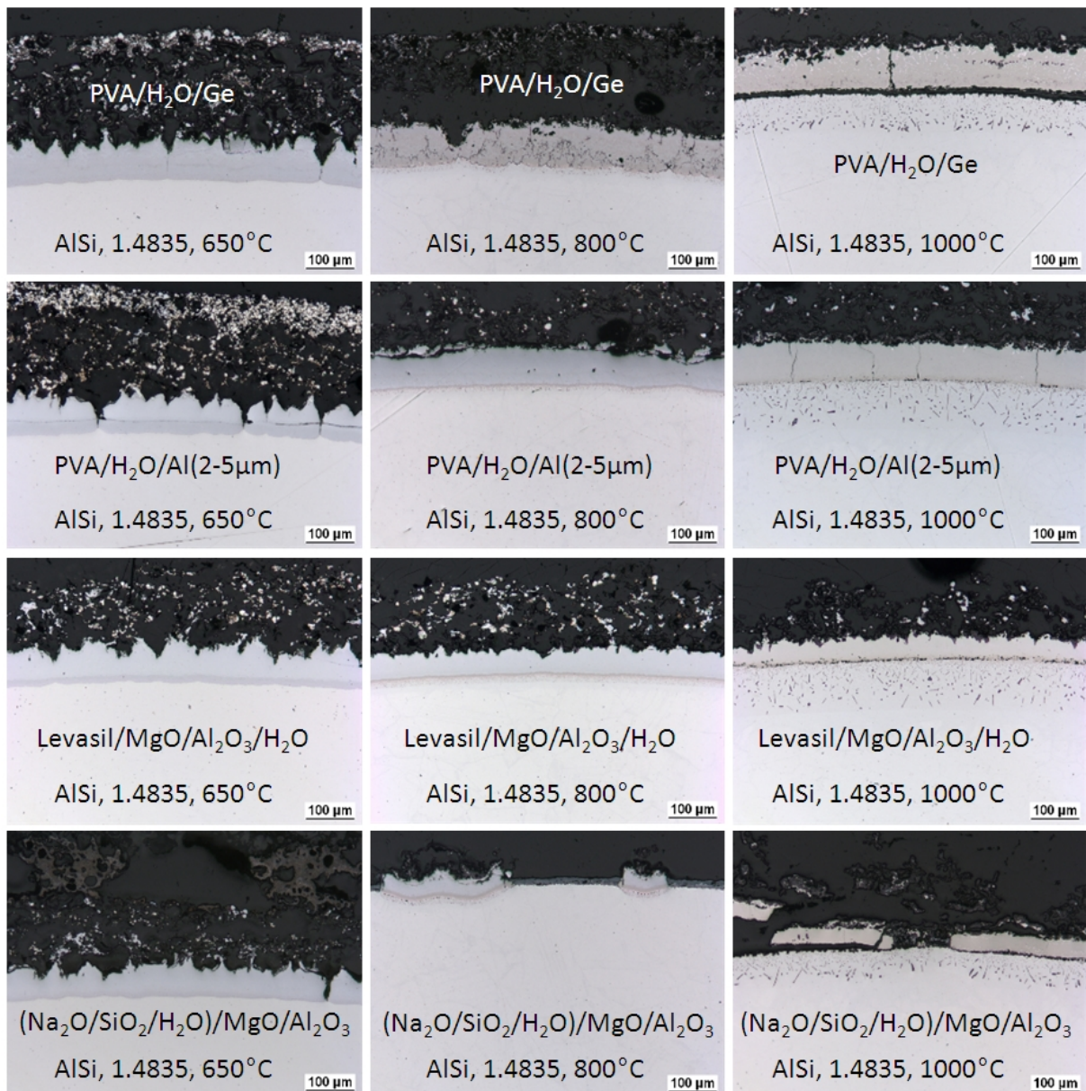
Bild 6.11: Ergebnisse verschiedener Beschichtungssysteme an geätzten Proben, Werkstoff 1.4835
