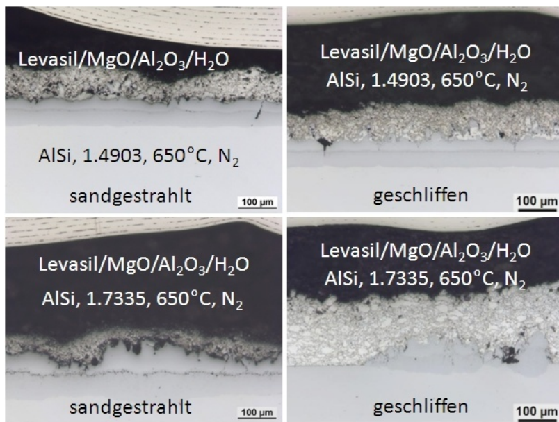
Bild 6.20: Einfluss unterschiedlicher Ausgangsbehandlungen auf das Beschichtungsverhalten von 1.4903 und 1.7335 mit dem Barrierenkonzept. Verwendet wurde eine Heizrate von 100K/h ohne Haltezeiten in N 2 -Atmosphäre.
