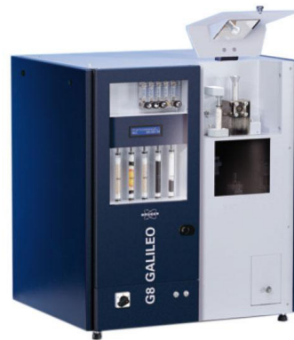
Abbildung 63: Fotografien (l.) des Zellaufbaus zur elektrochemischen Beladung der Proben mit Wasserstoff, (r.) des Bruker Galileo G8 TDA-Instruments zur Bestimmung des eingelagerten H 2 .
